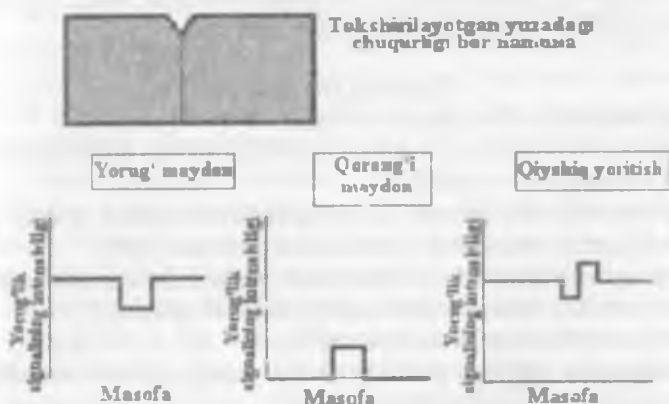
2.6-rasm. Nurlanish maydoni, qora maydon va qiyshiq yoritish usullaridan foydalanilganda chuqurligi mavjud nishon ko'rilganda nur intensivligini o'zgarish xususiyatlari.
