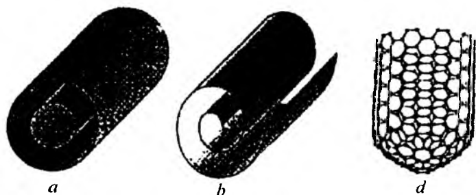
11.22-rasm. Ko'p qatlamli nanotrubkaning ko'ndalang kesim modeli: a – «russ matryoshkasi», b – shuttak; d – ko'ndalang tomondan epik bir qatlamli nanotrubkaning atomar strukturasi.
