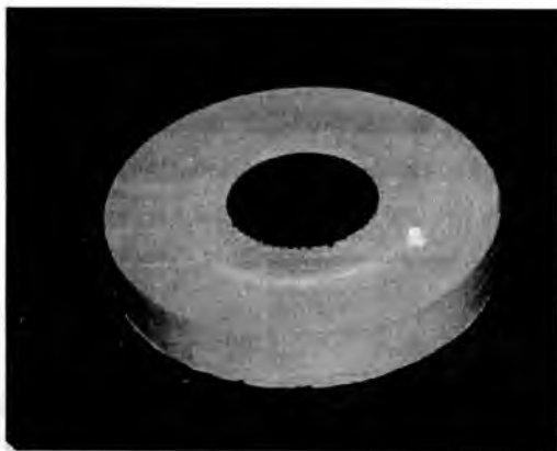
4.6-rasm. Tezkesar po'lat P6M5 bo'lgan matritsa
