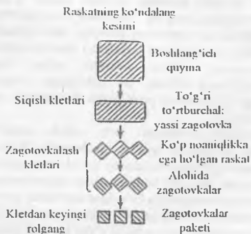
2.18 - rasm. Davomiy bo'linuvchi ko'p oqimli prokatlash sxemasi.
