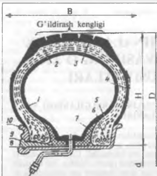
97-rasm. Yuk avtomobili kamerali shinasi to'g'in bilan yig'masining qirgimi:
