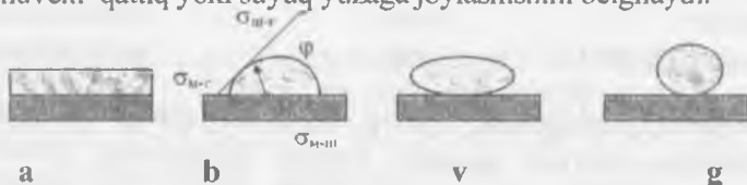
4.4.3. – rasm. Metall sirt ustiga shlakning suyuq tomchilarini joylashishining asosiy polatlari sxemasi. a- to'liq yoyilish ( f = 0 ); b – qisman yoyilish ( f < 90^\circ ); v – yomon yoyilish ( f > 90^\circ ); g – umuman yoyilmaslik ( f = 180^\circ ).
