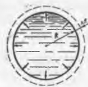
10.4 rasm. Gidravlik zarba vaqtida quvur devorining cho'zilishi.
