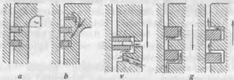
17.3-rasm. Porshen halqalari va ularning ishlash sxemasi
