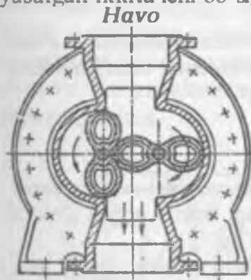
10.3-rasm. Havoning hajmiy sarfini o'lchovchi asbob sxemasi
