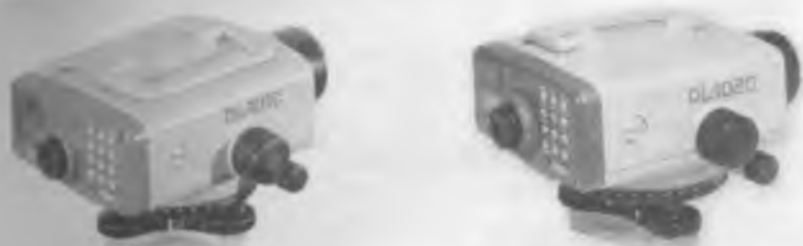
2.15-rasm. DL-101C , DL-102C TOPCON raqamli nivelirlari
