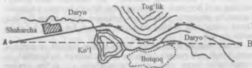
4.2-rasm. Temir yo'l liniyasining rejasi.
