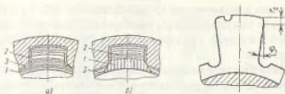
Рис. 4.12. Способы удаления припуска шлицевыми протяжками
