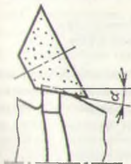
Рис. 4.10. Схема заточки выкружки на зубе протяжки
