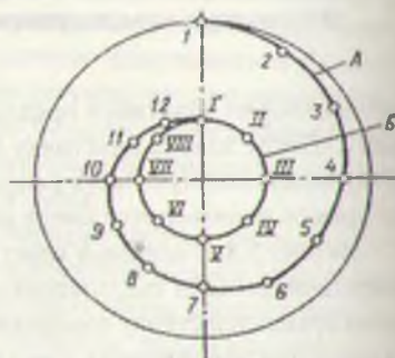
Рис.5.10. Спирально-ступенчатое расположение зубьев торцевых фрез
