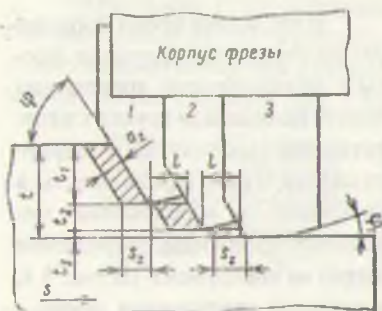
Рис.5.9. Ступенчатая схема резания при торцевом фрезеровании
