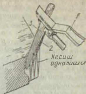
44- расм. Электродни ағдасимон ҳаракатлантириб ҳаво-ёй ёрдамида кесиб бўлиш схемаси:
