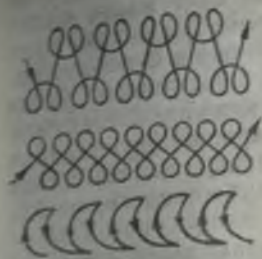
17-расм. Иккала қирраларнинг қизишини тезлатириш учун электродни тебранма ҳаракатлантириш схемаси.
