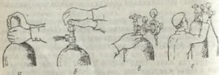
25- расм. Редукторни баллонга ўрнатиш:
