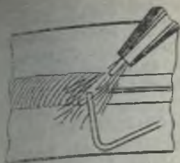
36-расм. Горизонтал чокларни пайвандлаш схемаси.
