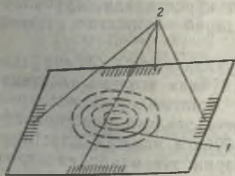
3-расм. Ўртасидан дўмбайган пластинани тўғрилаш схемаси.
