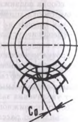
Рис. 6.10. Боковой зазор C_0 в зубчатой передаче
