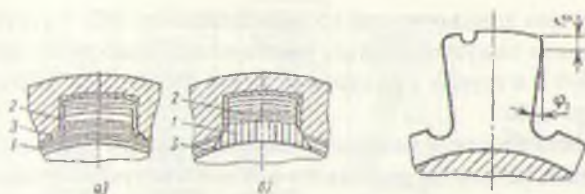
Рис. 4.12. Способы удаления припуска шлицевыми протяжками
