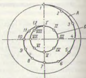
Рис.5.10. Спирально-ступенчатое расположение зубьев торцевых фрез
