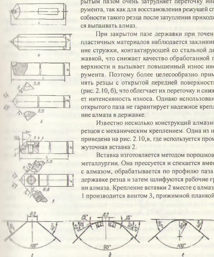
Рис. 2.10. Конструкции резцов с режущими элементами из алмаза и композита
