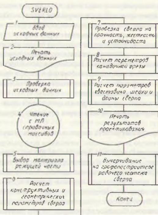
Рис. 10.9. Обобщенная блок-схема проектирования сверла
