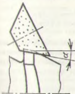
Рис. 4.10. Схема заточки выкружки на зубе протяжки
