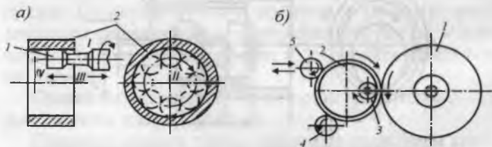
11.4-расм. Тешикларни жилвирлаш схемаси: а — планетарли; б — марказсиз
