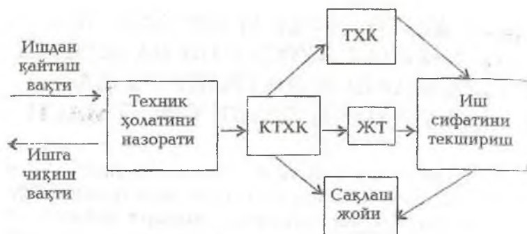
Расм 3. Автотранспорт хўжаликларида техник хизмат кўрсатиш ва таъмирлаш ишларини бажариш схемаси.
