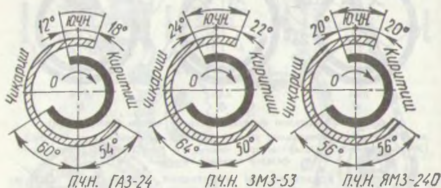
49-расм. ГАЗ-24 "Волга", ЗМЗ-53, ЯМЗ-240 автомобиль двигателларининг газ тақсимлаш фазалари тасвирий чизиги
