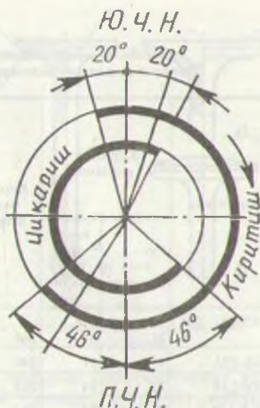
41-расм. ЯМЗ-238 Е автомобиль двигателни газ тақсимлаш фазаларининг доирасий тасвирий чизмаси.
