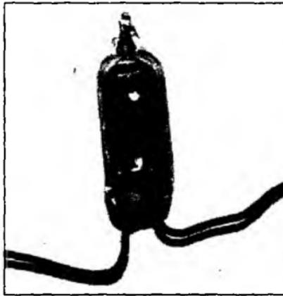
Рис. 3.32. Ртутный датчик положения
