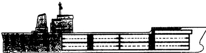
Рис. 8.5. Схема расположения охлаждаемых помещений на холодильном транспортном судне
