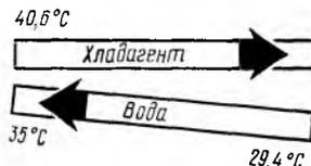
Рис. 97. Типичная схема противотока.
