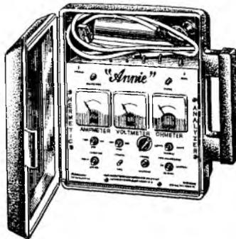
Рис. 188. Анализатор для герметичного компрессора.
