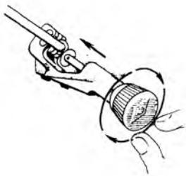
Рис. 22. Настройка трубореза.
