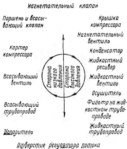
Рис. 6. Схема сторон высокого и низкого давлений.
