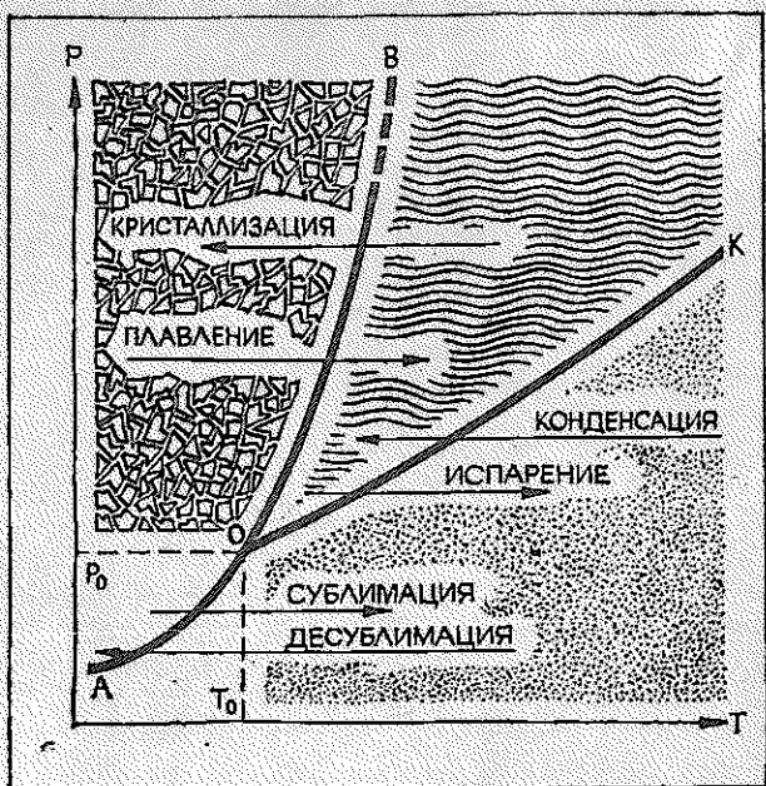
Рис. 9. Схема фазовой диаграммы воды
