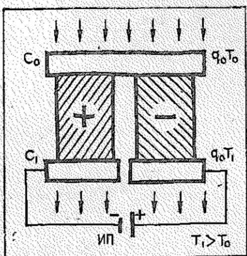
энергии, отбираемой от атомов ветвей термоэлемента в местах их сопряжения. В случае изменения направления тока на обратное электроны переходят на более низкий энергетический уровень, отдавая при этом избыточную энергию атомам кристаллической решетки, а спай нагревается.
