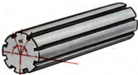
**158** К определению числа оборотов рукоятки делительной головки по шагу между осями канавок
