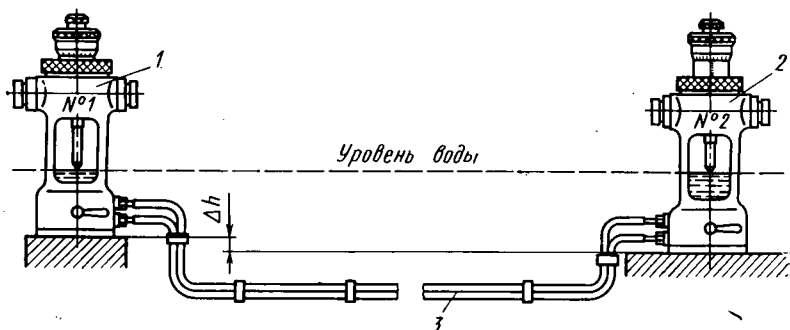
Рис. 255. Гидростатический уровень: 1, 2 — измерительные головки; 3 — шланги
