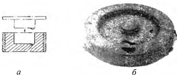
Рис. 68. Дефект - нарост: а - схема; б - дефектная отливка
