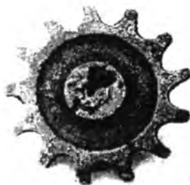
Рис. 72. Дефект - усадочная раковина:
