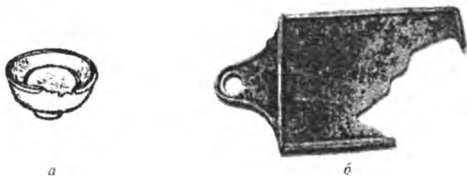
Рис.59. Недолив в результате недостаточной жидкотекучести (холодный металл): а-схема, б-дефектная отливка
