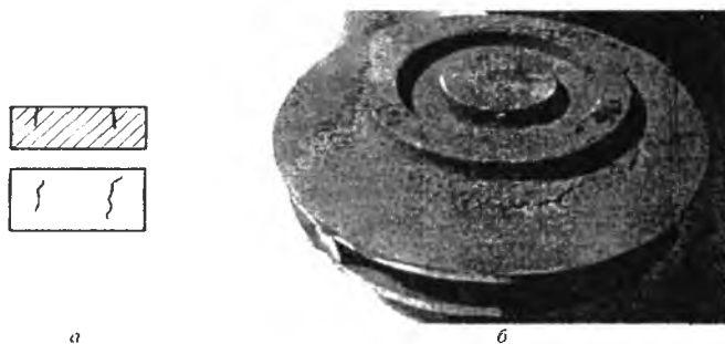
Рис. 69. Дефект - горячая трещина: а - схема; б - дефектная отливка
