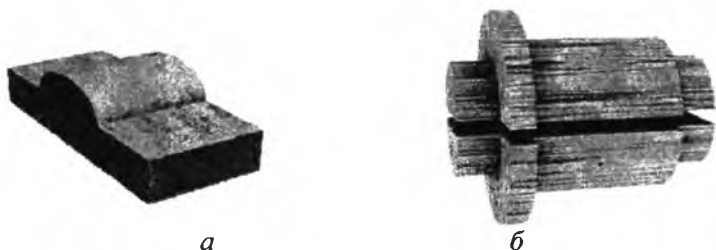
Рис. 13. Типы моделей: а - неразъемные; б - разъемные
