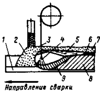
Рис. 6.1. Схема сварки под флюсом:
