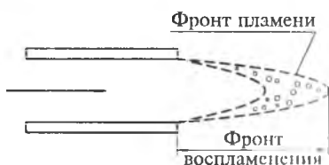
Рис. 7.2. Форма факела при турбулентном режиме горения топлива
