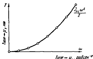
Рис. 539. График кинетической энергии звена привода в функции угловой скорости.
