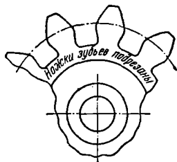
Рис. 639. Зубчатое колесо с подрезанными ножками зубьев.
