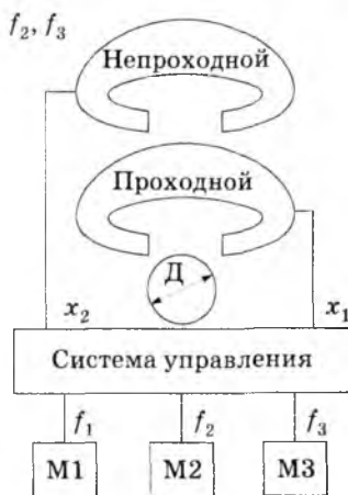
Рис. 7.9. Избирательная система управления сортировочным автоматом
