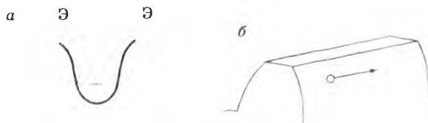
Рис. 5.20. Зацепления: а — цевочное; б — зацепление Новикова
