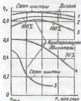
5.7-расм. Двигател ваги айланишлар частотасининг \eta_v га таъсири
