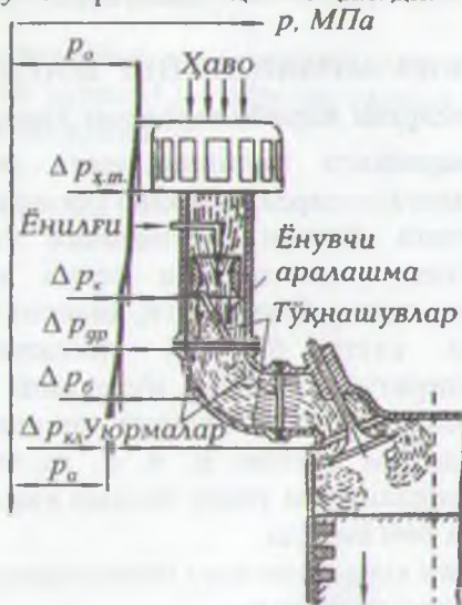
5.1-расм. Карбюраторли двигателнинг киритиш системаси бўйлаб заряд ҳаракатининг схемаси
