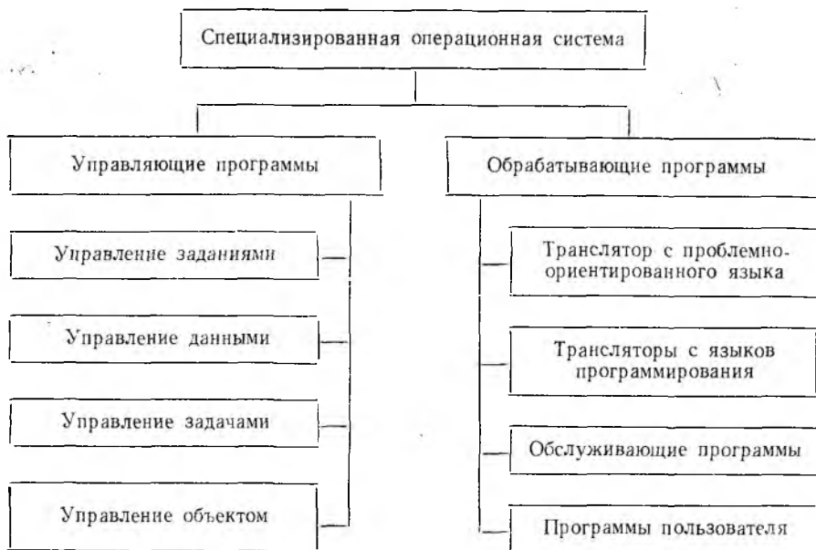
Рис. 5.24. Структура проблемно-ориентированной операционной системы
