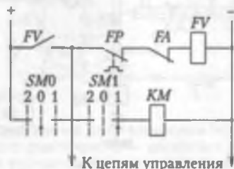
Рис. 2.27. Схема нулевой защиты
