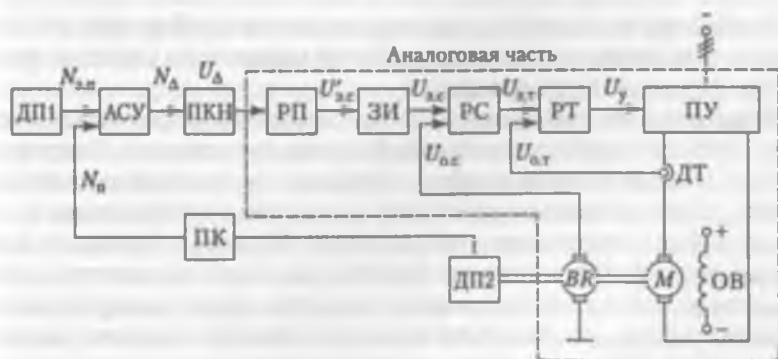
Рис. 4.20. Схема цифроаналогового следящего электропривода
