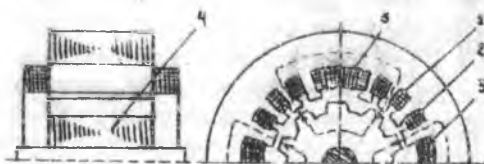
7.9.-расм. Ҳар хил ишора қутбли индуктор генератор: 1- статор пакети; 2- якорь чулғами ғалтаги; 3- қўзғатив чулғами ғалтаги; 4-ротор пакети.
