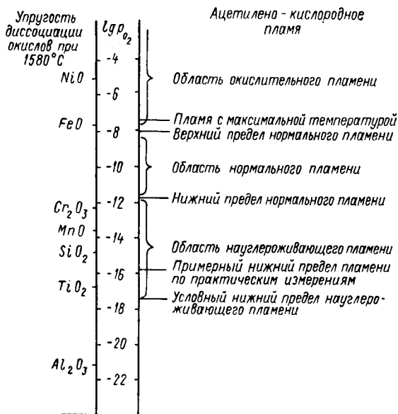
Рис. II.11. Номограммы сопоставления областей различной регулировки ацетилено-кислородного пламени и упругости диссоциации окислов различных элементов при 1580°C
