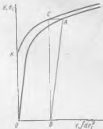
Рис. 4.8. Определение функции \Phi ( \epsilon^P ) по диаграмме растяжения материала
