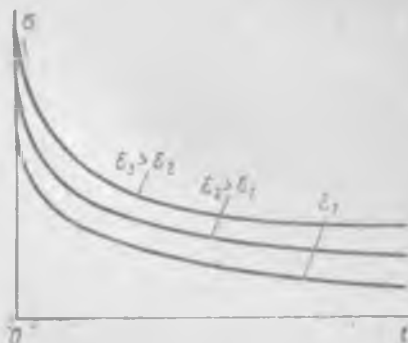
Рис. 12.2. Сечения поверхности в координатах \epsilon, \sigma, t плоскостями, перпендикулярными оси \epsilon , — кривые релаксации
