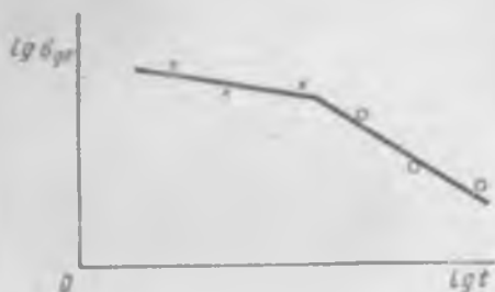
Рис. 11.20. График зависимости предела длительной прочности от времени испытания до разрушения
