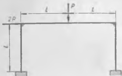
Рис. 10.12. Статически неопределимая рама с избыточным механизмом исчерпания несущей способности
