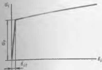
Рис. 5.9. Схематизированная диаграмма деформирования с линейным упрочнением
