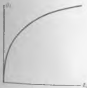
Рис. 5.11. Схематизированная диаграмма деформирования со степенным упрочнением без упругого участка
