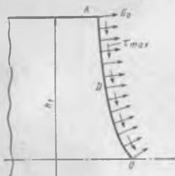
Рис. 9.35. Равновесие жесткой области на входе в матрицу
