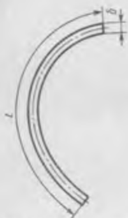
Рис. 13.13. Поперечное сечение скрученного бруса в форме тонкостенного незамкнутого профиля со стенкой постоянной толщины
