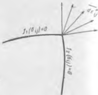
Рис. 4.5. К определению пластического течения на ребре поверхности пластичности
