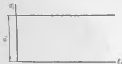
Рис. 5.15. Схематизированная диаграмма деформирования идеального жестко-пластического тела
