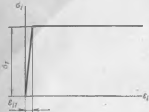
Рис. 4.4. Диаграмма деформирования идеального упруго-пластического материала
