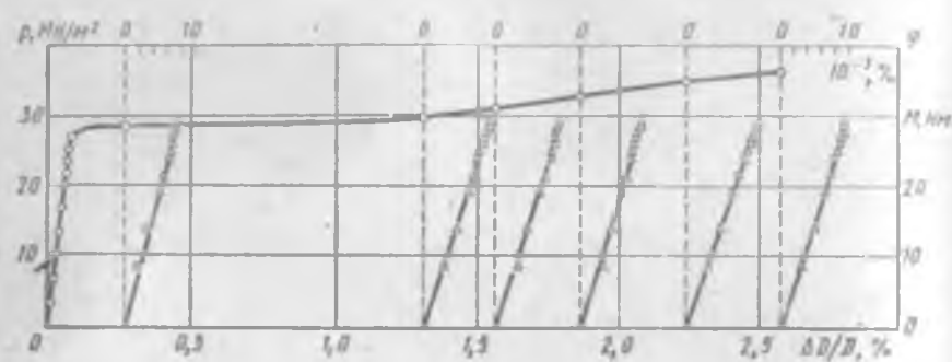
Рис. 4.20. График зависимости давления p от окружной деформации \frac{\Delta D}{D} , где D — средний диаметр трубки (кружочки) и графики зависимости крутящего момента M от угла закручивания \varphi при догрузке в опытах Ш. Н. Каца и Л. М. Качанова [22]
