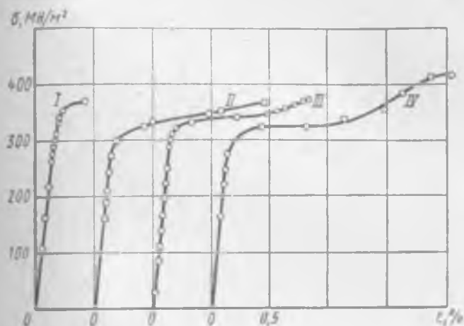
Рис. 4.18. Диаграммы предварительного растяжения в опытах А. М. Жукова и Ю. Н. Работнова [9]
