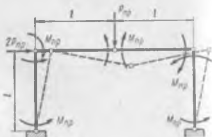
Рис. 10.13. Избыточный механизм исчерпания несущей способности рамы
