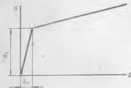
Рис. 4.26. Диаграмма растяжения с линейным упрочнением в координатах \epsilon^p , \sigma
