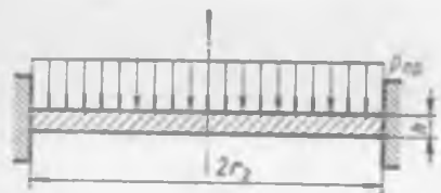
Рис. 10.31. Круглая пластина заделана по контуру и нагружена равномерно распределенной нагрузкой
