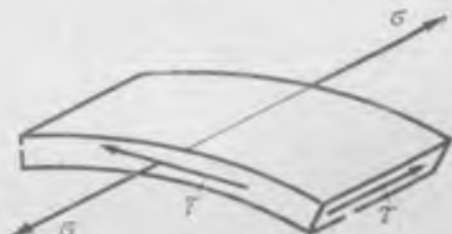
Рис. 12.18. Напряженное состояние при совместном растяжении и кручении трубчатого образца
