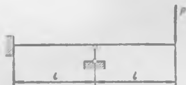
Рис. 10.11. Статически неопределимая балка с частичным механизмом истощения несущей способности
