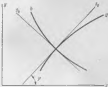
Рис. 9.7. Система координат s_a , s_b , оси которой направлены по касательным к линиям скольжения
