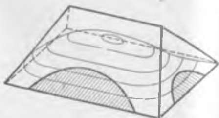
Рис. 10.23. Деформированная мембрана и поверхность постоянного ската
