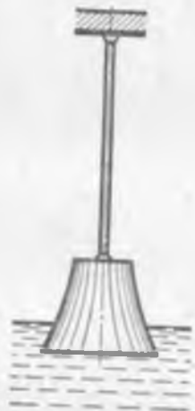
Рис. 11.9. Схема испытания образцов при постоянном напряжении в опытах Эндрейда [25]
