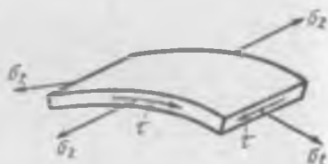
Рис. 13.18. Напряженное состояние элемента тонкостенной цилиндрической трубы, изображенной на рис. 13.17
