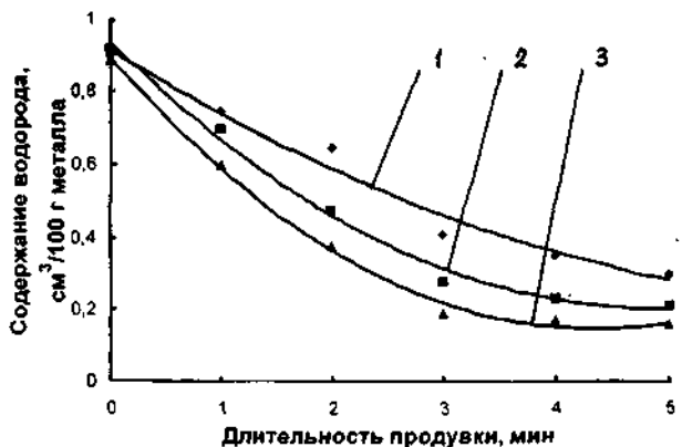
Рис. 2.7. Изменение содержания водорода при продувке сплава КС 740 азотом (1), смесью азота и гексахлорэтана (2), смесью азота и гексахлорэтана с использованием флюса (3)
