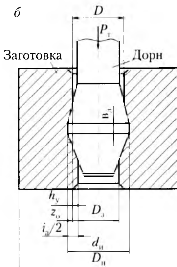
Рис 2.85. Зависимость износа И от числа Z , обработанных отверстий (а), параметры дорнов и режима дорнования (б); h_v — упругая деформация металла; z_0 — остаточная деформация; P_T — сила проталкивания дорна через отверстие); кривая 1 — без сульфидирования; кривая 2 — с сульфидированием
