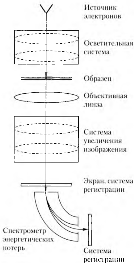
Рис. 3.2. Схема просвечивающего ЭМ
