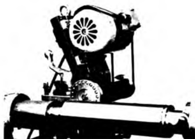
Рис. 2.33. Вибронакатывание цилиндрической поверхности штоков на токарно-винторезном станке с помощью ротационной многошаровой головки
