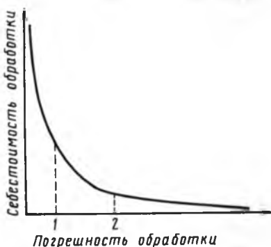
Рис. 2.3.17. Зависимость себестоимости обработки от погрешности (точности) обработки
