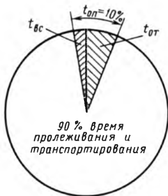
Рис. 1.13.11. Цикл изготовления детали в мелкосерийном производстве
