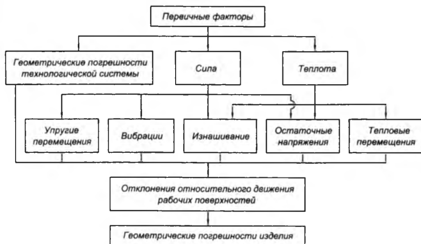
Рис. 1.6.2. Схема причинно-следственных связей формирования геометрических погрешностей
