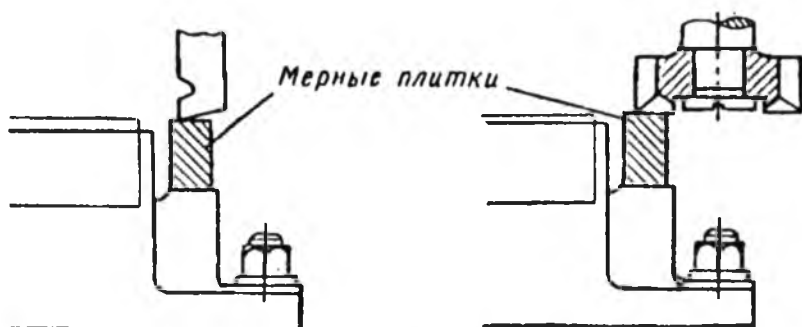
Рис. 1.10.14. Использование концевых мер для статической настройки
