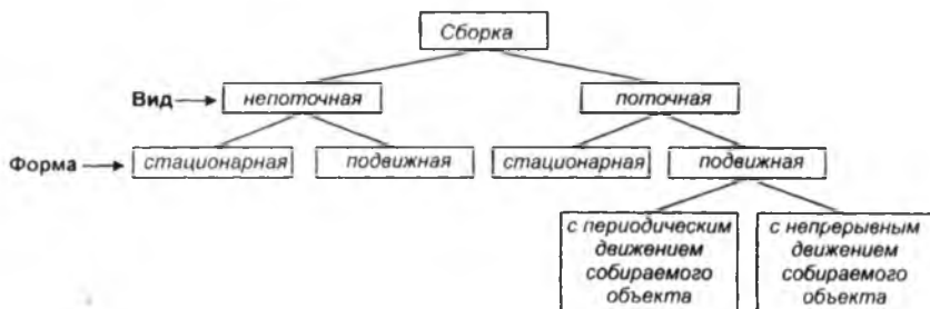
Рис. 2.2.1. Виды (поточная и непоточная) и организационные формы производственных процессов сборки изделия
