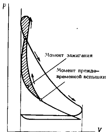
Рис. 5.5. Индикаторная диаграмма карбюраторного двигателя при преждевременной вспышке
