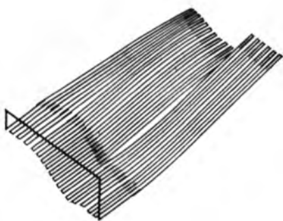
Рис. 7.34. Развертка строк фрезы для изготовления электрода (вычерчено автоматически)
