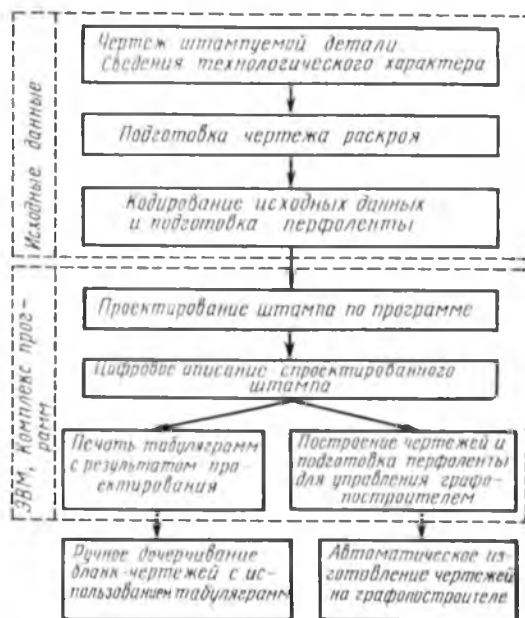
Рис. 7.41. Схема автоматизированного проектирования вырубных штампов
