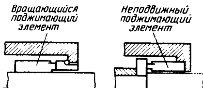
Рис. 3.6. Торцовые уплотнения с вращающимся и неподвижным элементами
