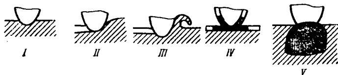
Рис. 25. Виды нарушения фрикционных связей по И. В. Крагельскому [31]
