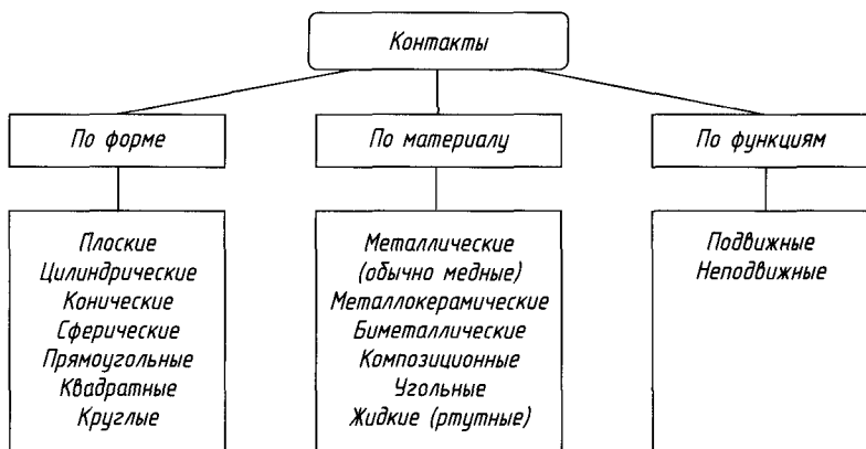
Рис. 13.5. Классификация контактов по форме и материалу
