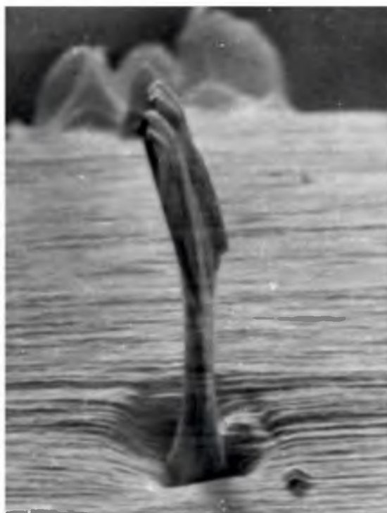
Рис. 12 Кольцевое углубление вокруг вискера. Вольфрам, \text{Ar}^+ , 1000 эВ. Увеличение-1000.
