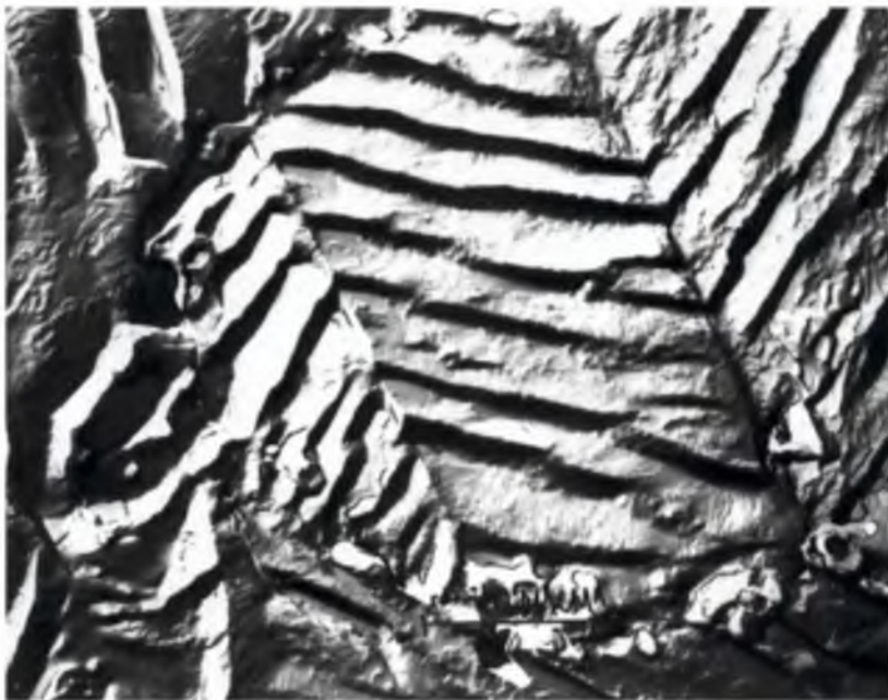
Рис. 1 Рельеф поверхности, полученный в результате облучения сплава ЭП-125 ионами дейтерия с энергией 3 кэВ. Доза облучения 10^{20} \text{ см}^{-2} .
