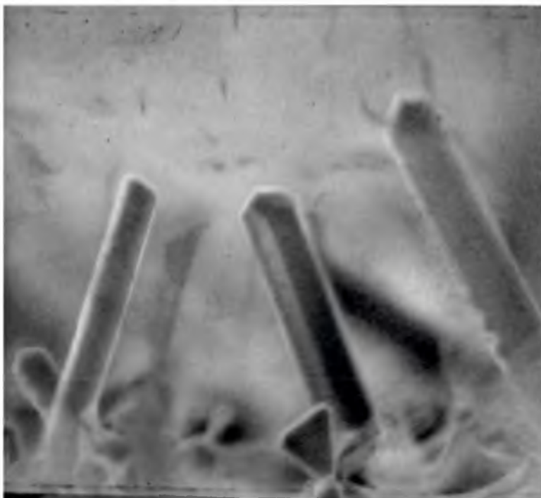
Рис. 5 Вискеры правильных геометрических форм (призмы, пластины). Медь, ионы \text{Hg}^+ , 50 эВ. Увеличение –3000.
