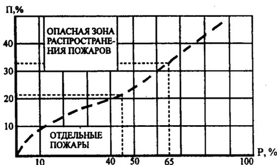
Рис. 7.1. Зависимость вероятности возникновения и распространения пожаров от плотности застройки
