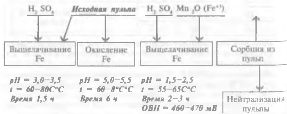
Рис. 1.6.5. Комбинированная схема извлечения урана с использованием в качестве окислителей пиrolюзита, выщелаченного и окисленного кислородом воздуха рудного железа
