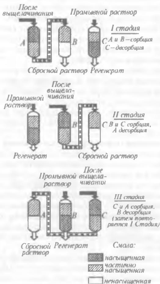
Рис. 1.8.16. Последовательность процессов при извлечении урана из раствора (стадия промывки пропущена)
