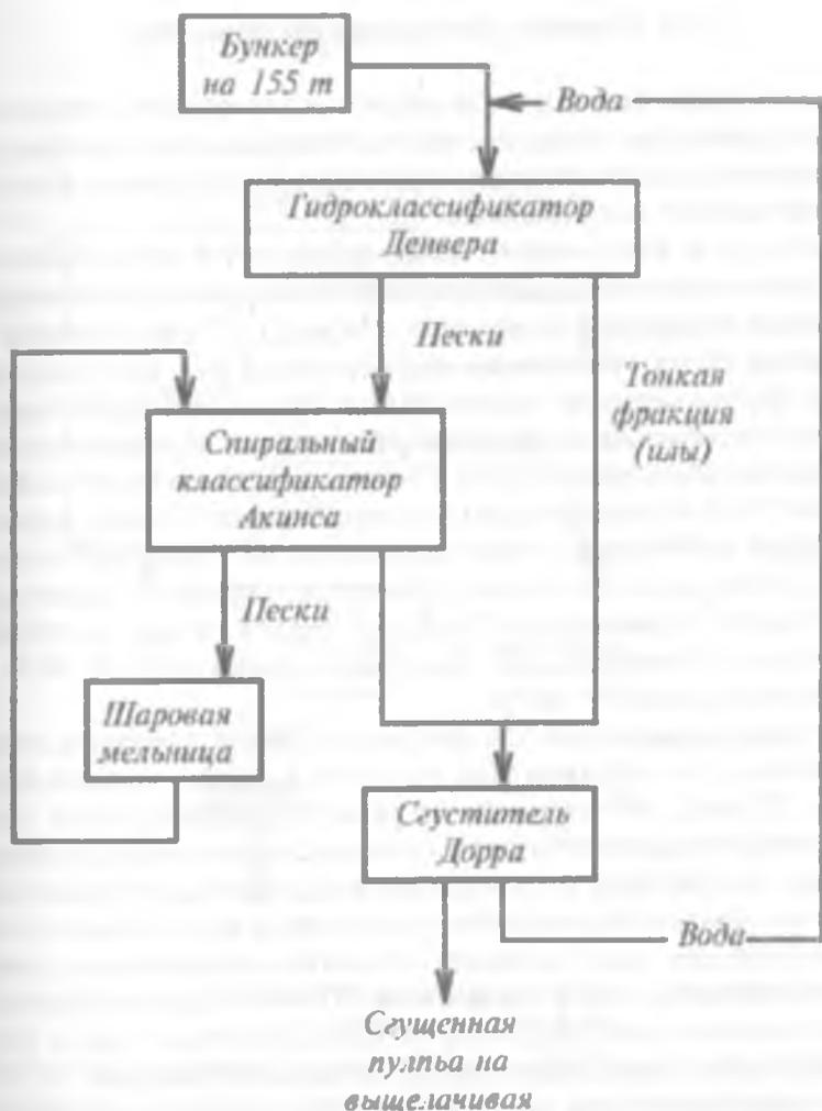
Рис. 1.5.2. Схема измельчения урановой руды на заводе Эльдorado
