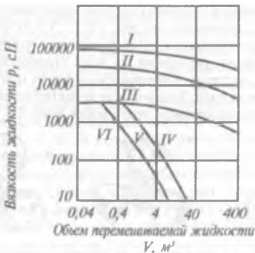
Рис. 1.6.15. График, иллюстрирующий выбор пропеллерных, турбинных и лопастных мешалок.
