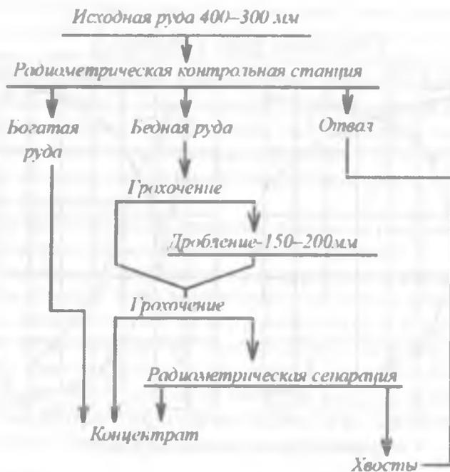
Рис. 1.5.5. Схема радиометрического обогащения урановой руды
