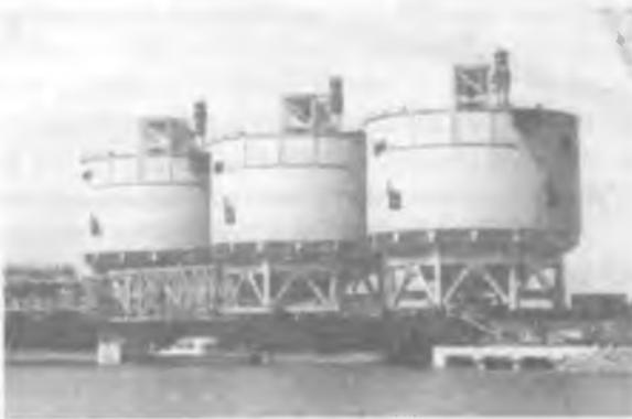
Рис. 1.7.8. Каскад из трех сгустителей для противоточной декантационной промывки пульп
