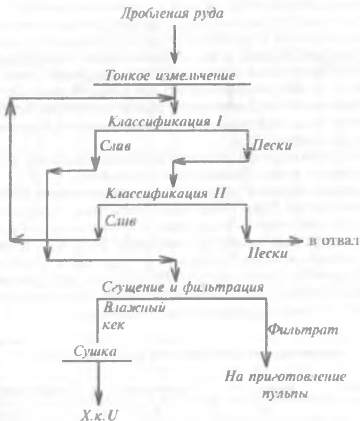
Рис. 1.5.3. Технологическая схема обогащения карнотитовых руд методом ошламования
