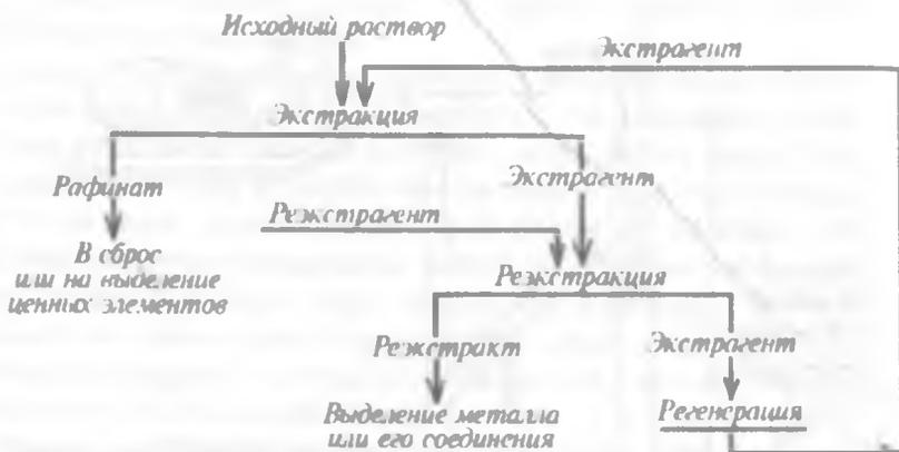
Рис. 1.9.1. Принципиальная схема экстракционного или лечения металла из раствора
