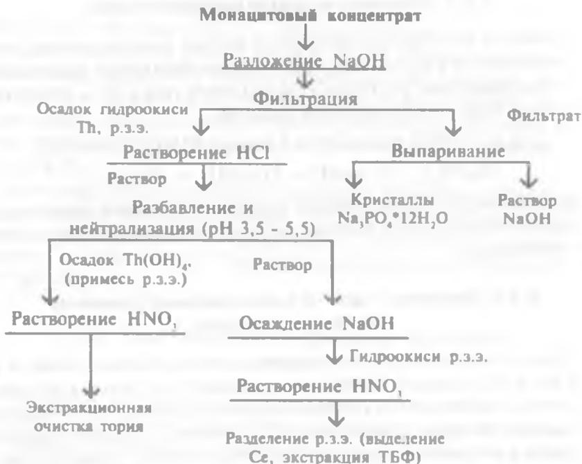
*Рис. 2.5.1. Принципиальная технологическая схема переработки монацита*
