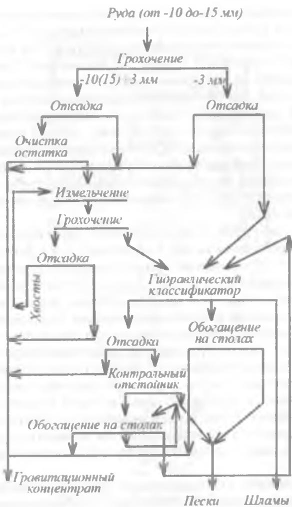
Рис. 1.5.13. Схема гравитационного обогащения силикатных урановых руд
