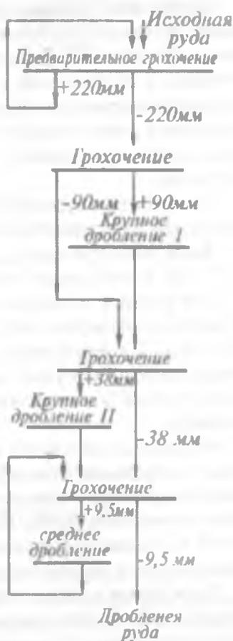
Рис. 1.5.1. Технологическая схема крупного и среднего дробления урановой руды на заводе в Эльдorado (Канада)
