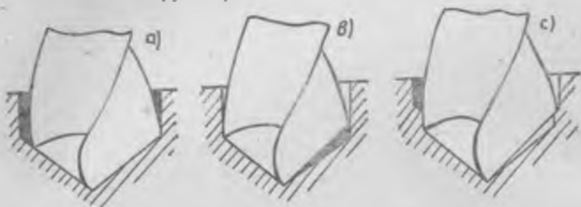
473- расм. Пармани симметриксиз чархлаш таъсири.
