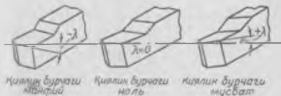
387- расм. Киялик бурчагининг ажралаётган қиринди йўналишига таъсири.
