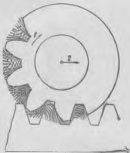
519- расм. Рейка воситасида тишли ғилдирак ишлаш схемаси.
