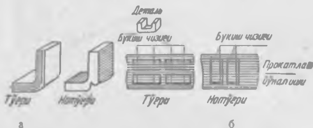
185- расм. Букиш процессига толалар йўналишининг таъсири.
