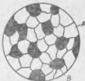
12- расм. Механик аралашманинг микроструктура схемаси.
