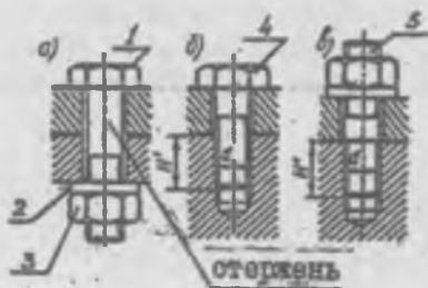
1-болт; 2-шайба; 3-гайка; 4-винт; 5-шпилька
