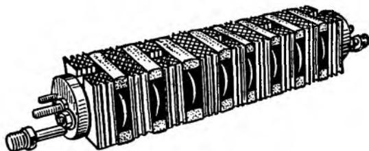
Рис. III-13. Безызоляционный модуль типа «жидкость — воздух».
