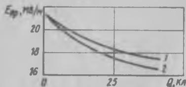
Рис. 5.40 Зависимость  $E_{пр}$  высоковольтного фарфора от количества электричества, прошедшего через образцы толщиной 7 мм:
