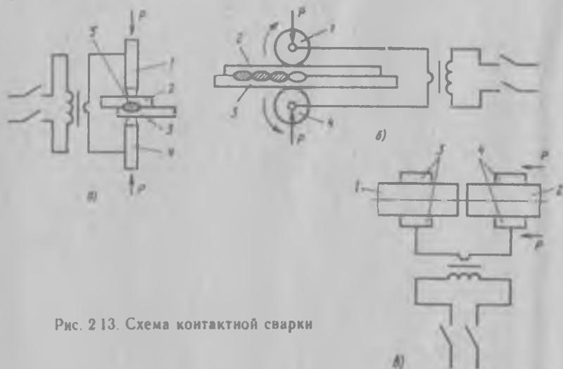
Рис. 2.13. Схема контактной сварки
