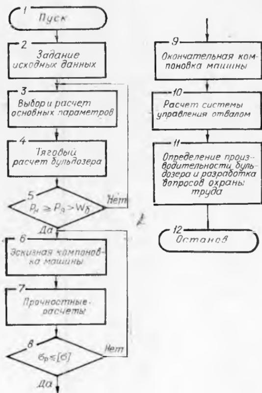
Рис. 3. Блок-схема расчета бульдозера.
